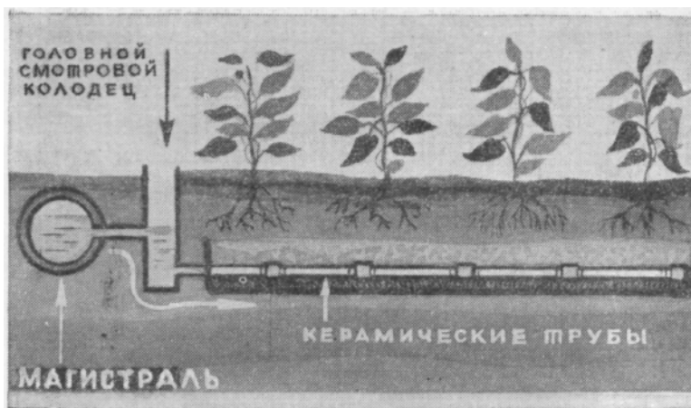
Керамические трубы подпочвенного орошения располагаются перпендикулярно к основной магистрали.
